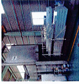
T5炉にて熱処理で 強度を高める。
